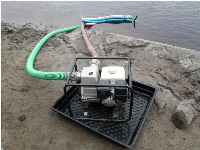
**Photo 10** Pompe à eau mécanique utilisée
