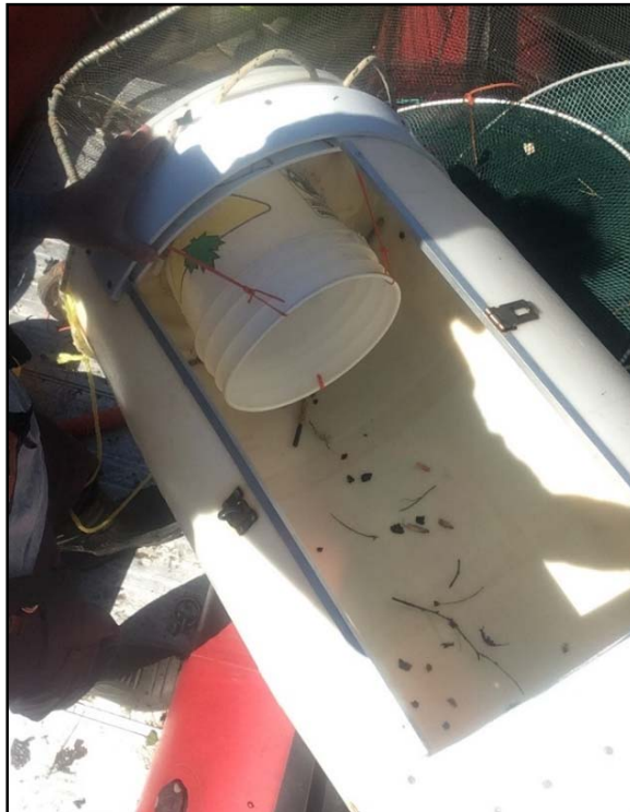
Photo 8 Dispositif visant à diminuer la vitesse du courant dans la chambre de récupération des smolts d'un engin de pêche.
