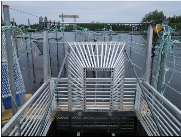
Photo 3 : Cage de capture avant son installation
