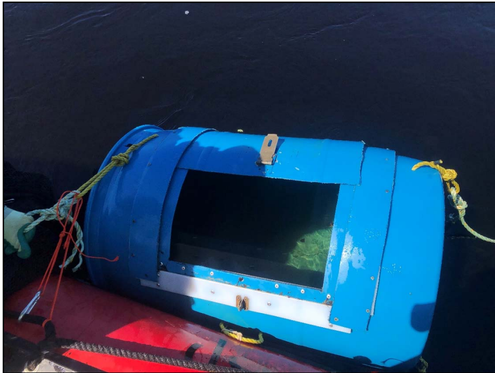
Photo 4 Vérification de la présence de smolts dans la chambre de récupération d'un filet-trappe.
