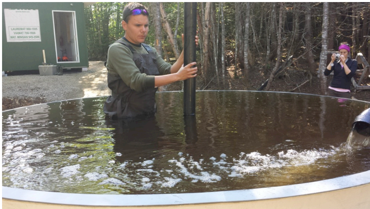
Photo 6.2 : Procédure de débordement des bassins pour éliminer les corps gras en surface de l'eau
