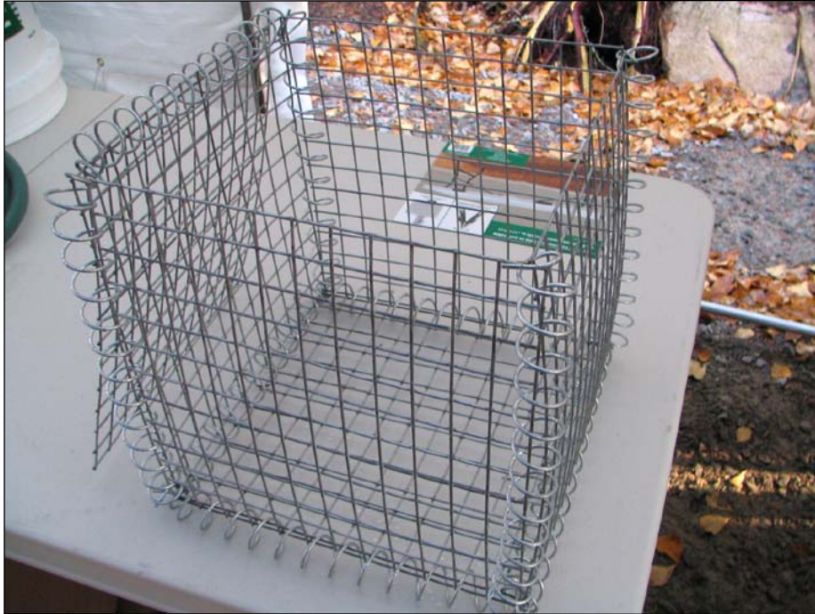
Photo 1 – Aperçu d'un dispositif d'implantation en gabion
