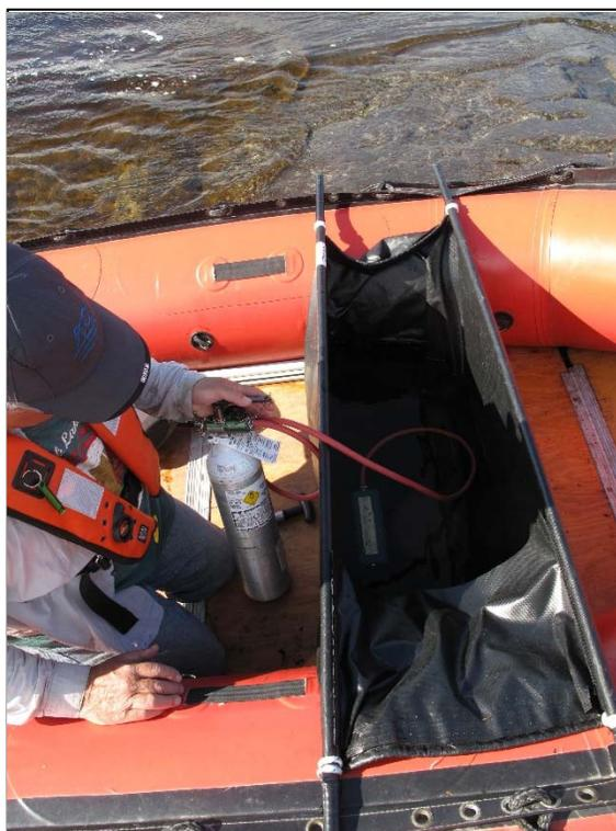
Photo 14. Installation du diffuseur à oxygène dans la civière
