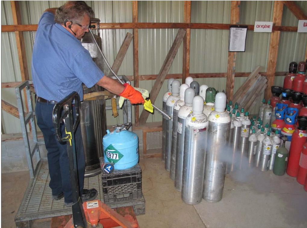
Photo 3. Essai de manipulation de l'azote liquide
