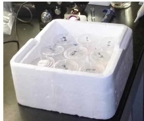
**Figure 19. Laitance extraite placée sur du refroidissement dans une glacière avant d'être caractérisée**
