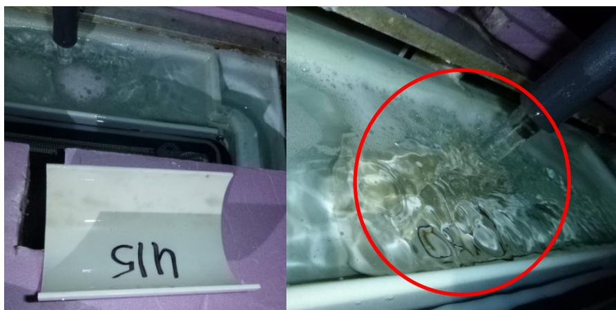
**Figure 31. Section de tuyau en PVC utilisée pour dévier le jet d'arrivée d'eau et empêcher la formation de grosses bulles d'air sous les œufs**
