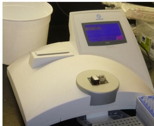
**Figure 21. Spectrophotomètre SDM6 utilisé pour déterminer la densité de spermatozoïdes de la laitance**
