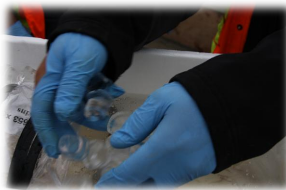
Photo 11. Ajout de glace afin de maintenir la température de l'eau des sacs proche de celle de la rivière.
