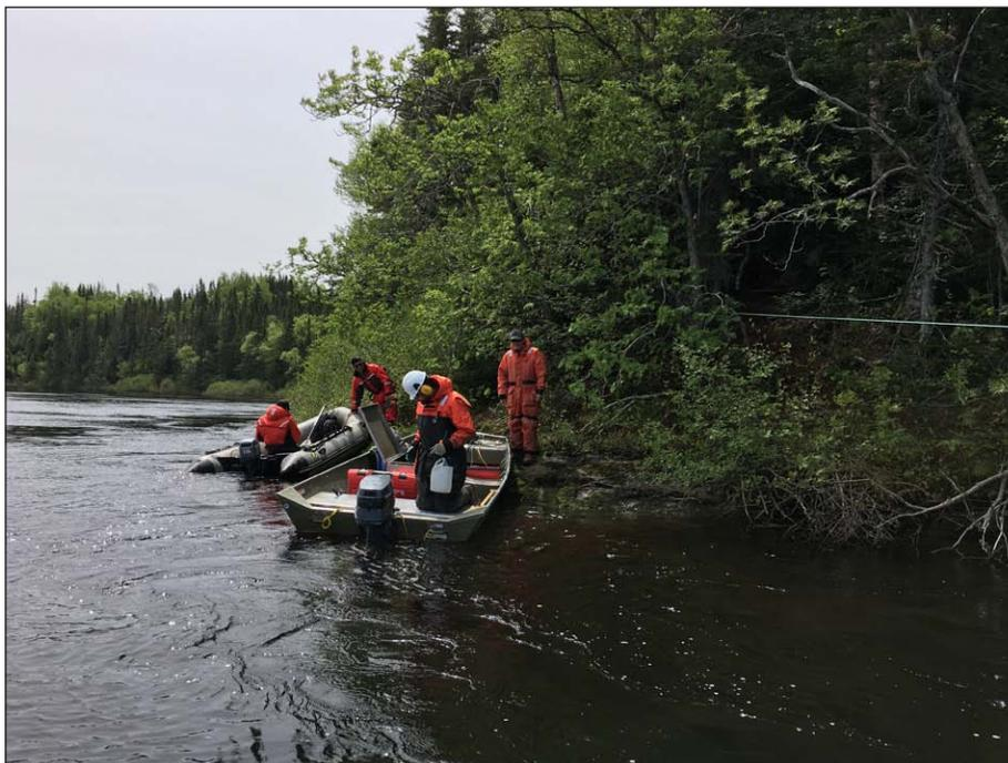
Photo 2 – Ancrage du filet-trappe SR01 en rive droite de la Romaine
